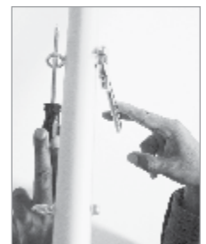
Figure 9: Serrez les boulons avec deux doigts
