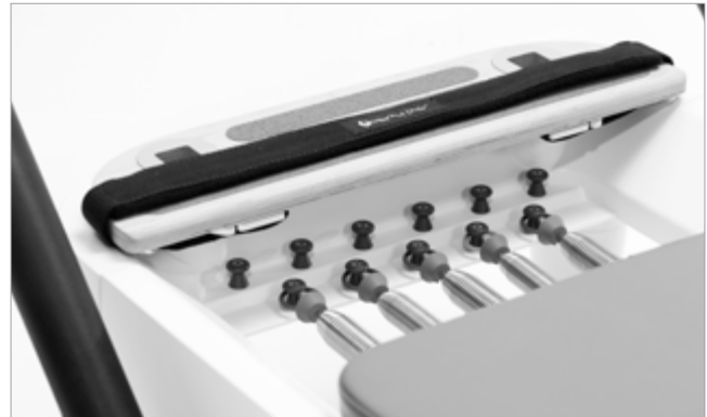
Vérifiez régulièrement l'état des ressorts et remplacez-les si nécessaire. Nous recommandons de remplacer les ressorts tous les deux ans (une fois par an pour les cours de fitness en groupe).
