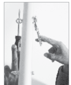
Figura 9: Usare due dita per stringere i bulloni
