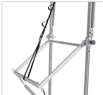
Figure 6: sangle de sécurité maintenant la barre traversante à 4 heures. La sangle est fixée au cadre PTB et à la structure, pas aux boulons à œil.
