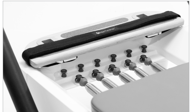
Controllare regolarmente l'usura delle molle e sostituirle, se necessario. Si consiglia di sostituire le molle ogni due anni o ogni anno in caso di corsi di fitness di gruppo.
