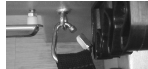
Figura 2: Buen encaje: no hay desgaste en el gancho.
